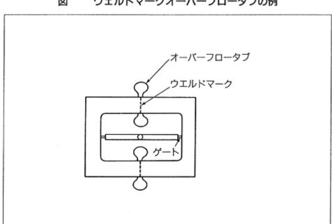
図 ウェルドマークオーバーフロータブの例
